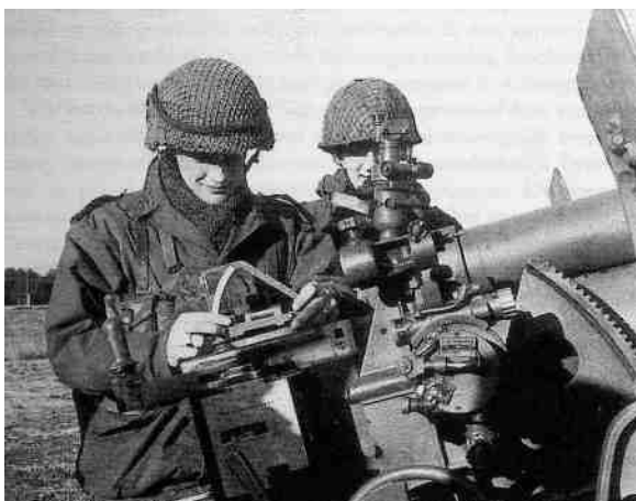
Een wachtmeester, stukcommandant stelt het kwadrant in. De vuurmond is de 105 mm houwitser.
