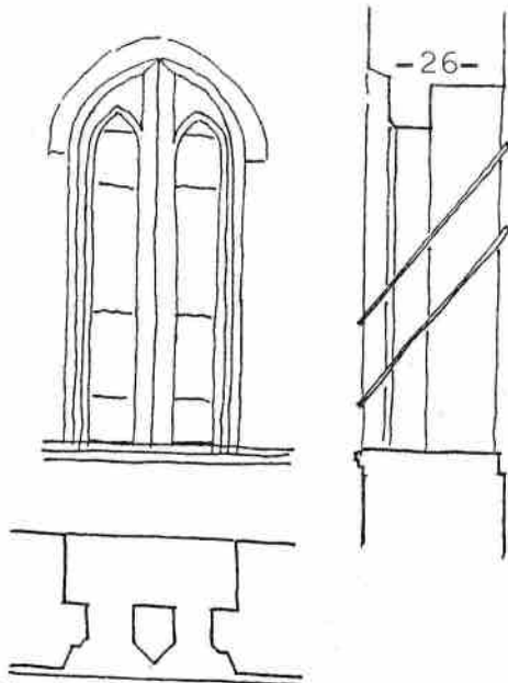
fig. 5 Gekoppeld paar galmgaten, waarvan er aan elke gevel van de toren twee voorkomen. Dit motief is afkomstig uit de romaanse bouwwijze, maar heeft in de dorpsgothiek van de Kempen een aantal eigen varianten gekregen. Hier met een overhoekse pilaster tussen de openingen. (naar een opmetingstekening van het architectenburo van der Laan-Hansen en van Hal, mei 1956)
