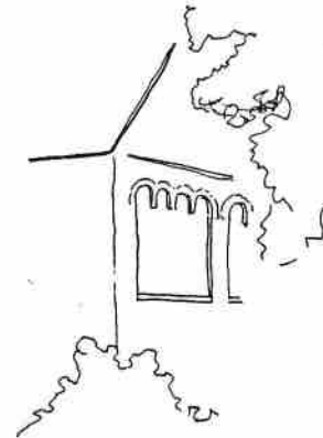
fig. 9 Spaarvelden aan het Boterkerkje te Oirschot, afgedekt met elk vier rondboogjes. Het Boterkerkje van Oirschot dateert uit de twaalfde eeuw en is gebouwd in de romaanse stijl.
