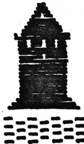
fig. 8: Ingemetselde tekens aan de zuidgevel. De burchttoren is een weinig voorkomend teken. Onder een deel van het koppenpatroon zoals dat over een groot deel van de noord- en de zuidgevel van de onderste geleiding voorkomt.
